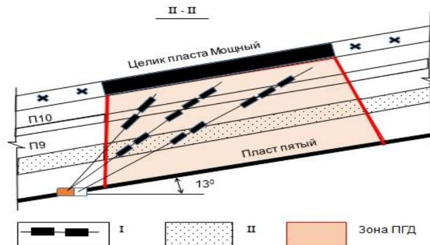
Схема расположения скважин ГМТ в зоне ПГД:
