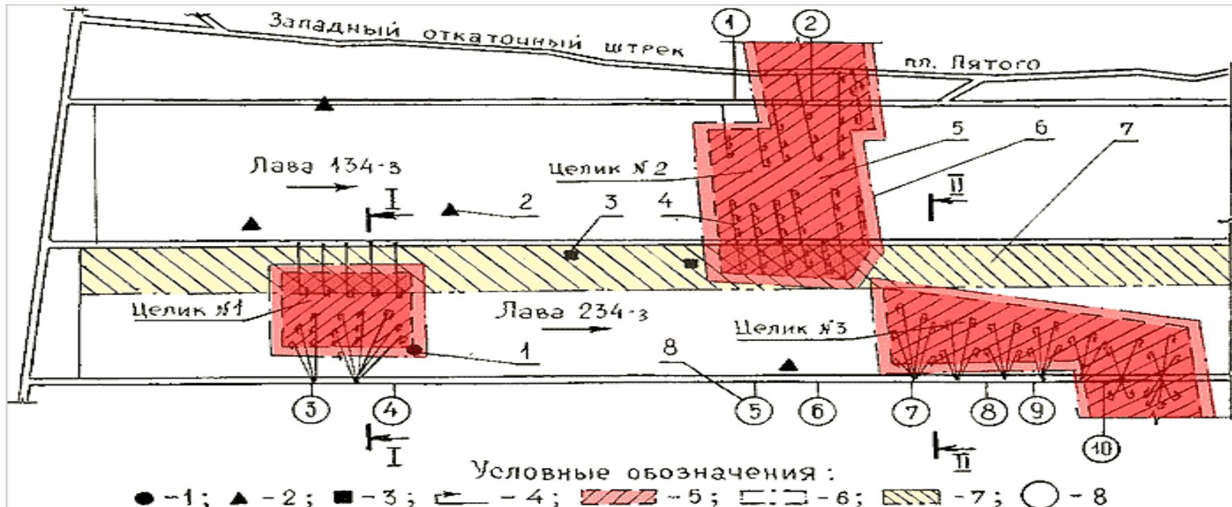
Схема расположения скважин по пласту Пятому в западном крыле шахты «Юр-Шор»:
