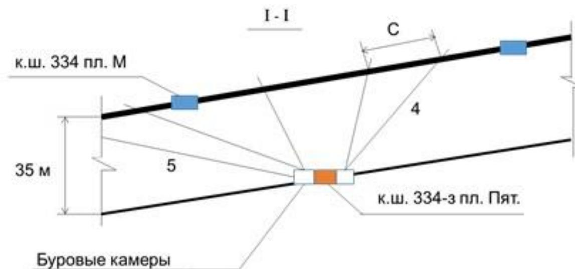
Бурение кустов скважин осуществлялось станком СБГ-1М из буровых камер, пройденных по падению и восстанию. Расстояние между скважинами  $C=2R_{эф}$  составляло в среднем 30м, расстояние между скважиной и контуром конвейерного штрека 334-з пласта Мощного - не менее  $1,5 R_{эф}$ ., угол наклона скважин к горизонту варьировал от  $5^\circ$  до  $75^\circ$ , длина скважин – от 39 м до 112м.
