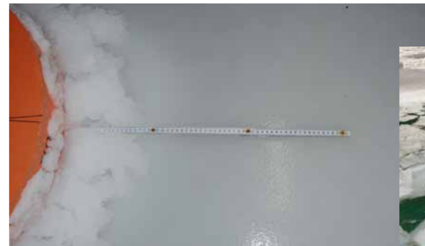
Измерение размеров надводных нагромождений обломков льда
