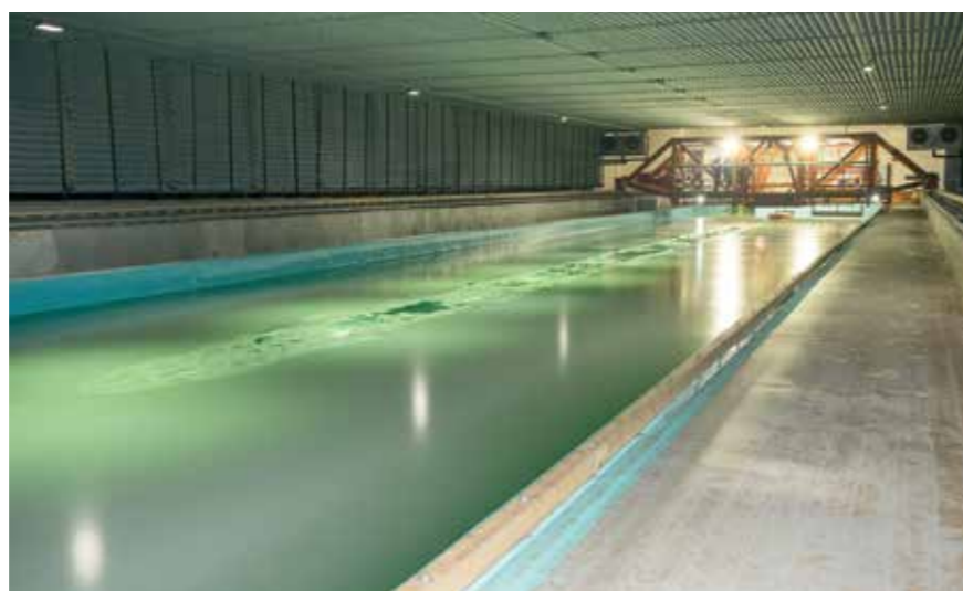
Пример ледового опытового бассейна
