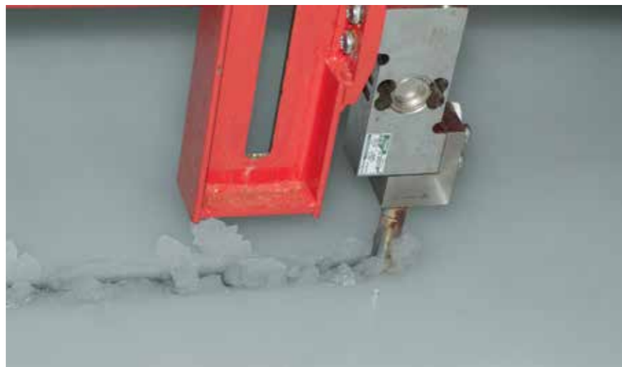
Прорезание индентором ледяного поля
